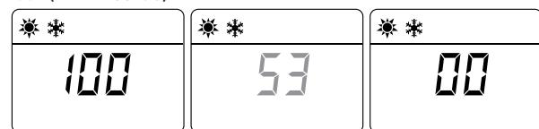
De operator dient ongeveer 15 minuten te wachten totdat de "Automatische kalibratieprocedure" beëindigd wordt en op het display opnieuw de "ZOMER-modus" verschijnt. Als de procedure voltooid is:
