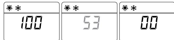
Der Bediener muss etwa 15 Minuten warten, bis auf dem Display wieder der Modus „SOMMER“ ☀ angezeigt wird. Dann ist die „Vorgehensweise zur Selbstkalibrierung“ abgeschlossen. Nach Abschluss der Vorgehensweise:
