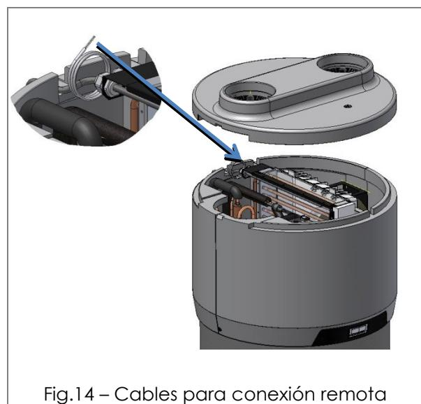
Fig.14 – Cables para conexión remota
