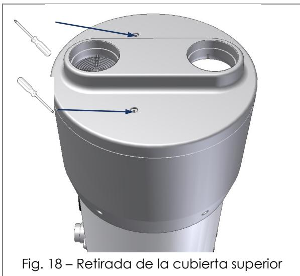
Fig. 18 – Retirada de la cubierta superior
