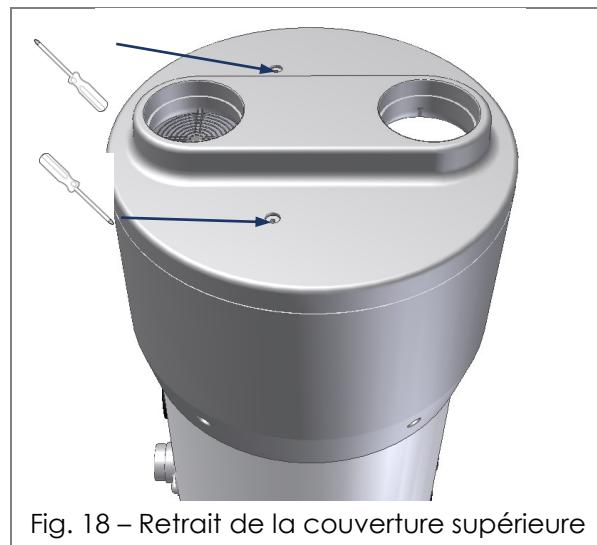
Fig. 18 – Retrait de la couverture supérieure
