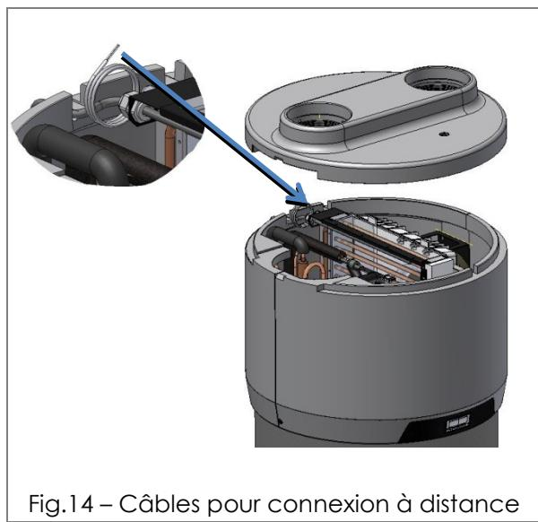
Fig.14 – Câbles pour connexion à distance
